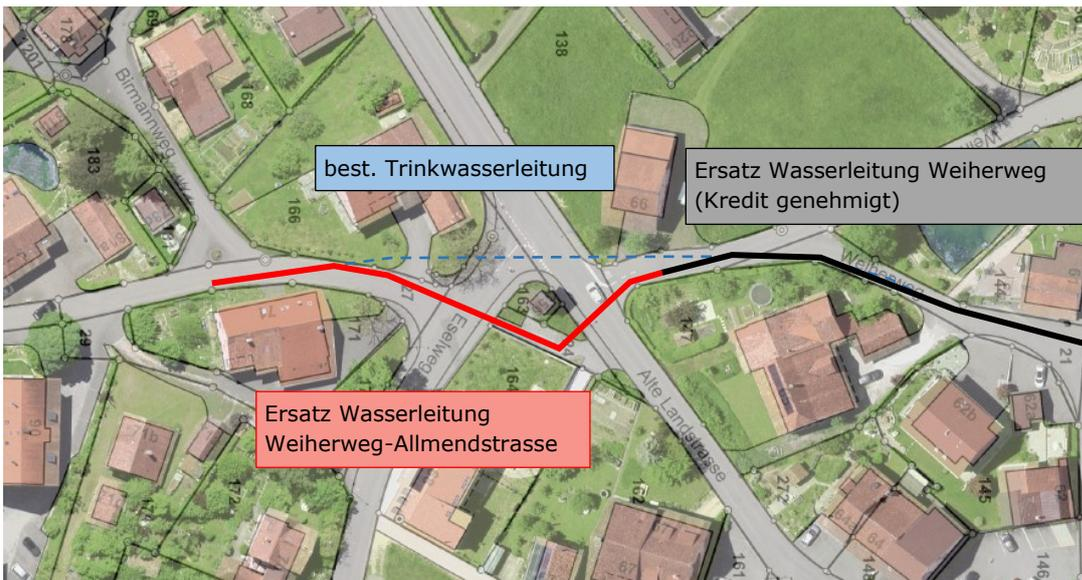
Das Projekt umfasst den Ersatz der Trinkwasserleitung im Abschnitt Alte Landstrasse Nr. 66 – Allmendstrasse Nr. 71. Die Linienführung der neuen Trinkwasserleitung wird angepasst, sodass keine privaten Parzellen mehr beansprucht werden. Die Kantonsstrasse (Alte Landstrasse und Eselweg) muss mit der neuen Leitung gequert werden.
